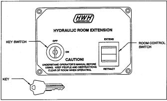
HYDRAULIC SLIDE OUT ROOM OPERATOR'S PANEL
