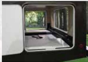
Rangement extérieur pleine largeur - fait de plastique polymère anticorrosion, les compartiments de rangement extérieurs durables et sans joints sont construits pour durer avec deux ou trois portes d'accès. (plupart des modèles)
