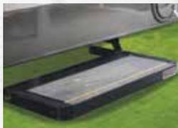
Marchepied électrique et porte de 80" avec rangement pour deux batteries auxiliaires.
