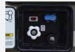
Remplissage pour eau fraîche, connexion pour l'eau de la ville, système de rinçage des eaux noires et interrupteur pour la pompe d'hivernisation.
