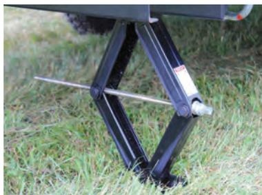
Les quatre robustes stabilisateurs ciseaux se montent et se rétractent très facilement avec une perceuse sans fil et avec la tête Canimex.
