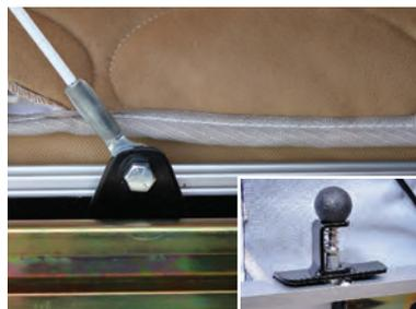
L'exclusif système de câble "Glide-N-Lock" élimine les pôles de support en dessous des lits. Tirez simplement les lits jusqu'à ce qu'ils se sécurisent en place et installez les chevrons de tension.
