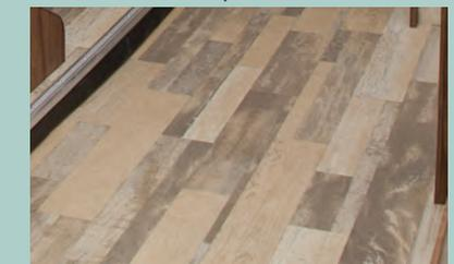
La structure de plancher en contreplaqué de 5/8" sans joint de Viking est plus robuste que celle de 1/2" de la compétition. Une couche de peinture de style automobile protège le plancher contre les éléments et le couvre-plancher Congoleum Diamondflor qui est 100% adhésif augmente la durabilité et donne une très belle apparence.
