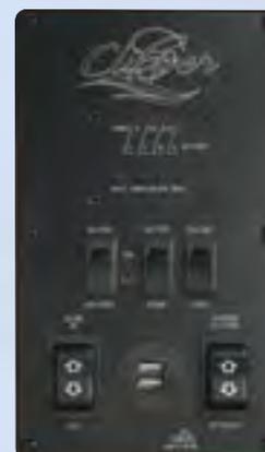
Panneau de contrôle intérieur qui contrôle l'auvent, les lumières intérieures, rallonges, chauffe-eau/pompe, l'indicateur de batterie et deux ports de chargement USB
