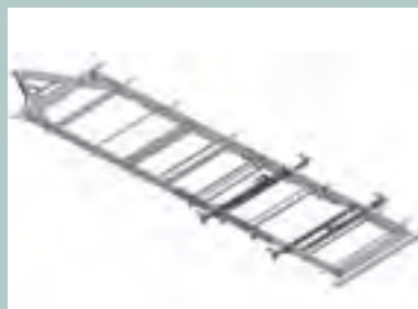
Châssis Norco NXG avec la technologie E-Coat
